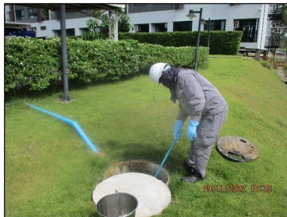
รูปที่ 3.3 การเก็บตัวอย่างคุณภาพน้ำทิ้ง บริเวณน้ำก่อนการบำบัดอาคาร B
