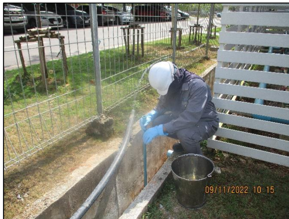
รูปที่ 3.8 การเก็บตัวอย่างคุณภาพน้ำทิ้ง บริเวณน้ำหลังการบำบัดอาคาร C
